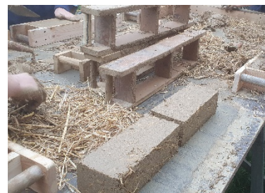
Beim Besuch in der Jugendbauhütte Görlitz wurden erste Erfahrungen im Umgang mit Lehm gesammelt. Hier entstehen historische Lehmziegel.
